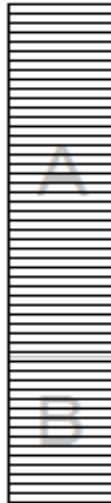
Figur 8.4: Illustrativ tolkning av kolumnVektor; vars element består av de databytes, som utgör kolumn-objektet. Varje element innehåller en byte.
