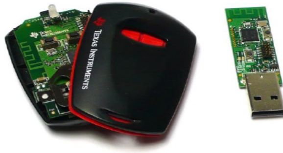
Figur 3.1: Illustrerar Texas Instruments CC2540 Keyfob (vänster) och Dongle (höger) (se [1] sidan 4).
